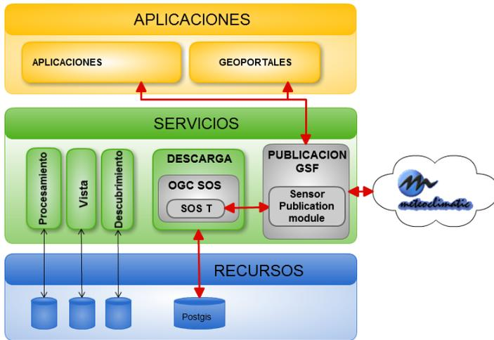
*Figura 1: Arquitectura basada en INSPIRE extendida con el servicio de Publicación y en particular con el módulo de publicación de datos de sensores meteorológicos.*
